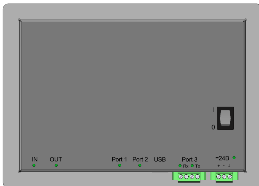
Рисунок 3 - Вид сзади контроллера REGUL R400
