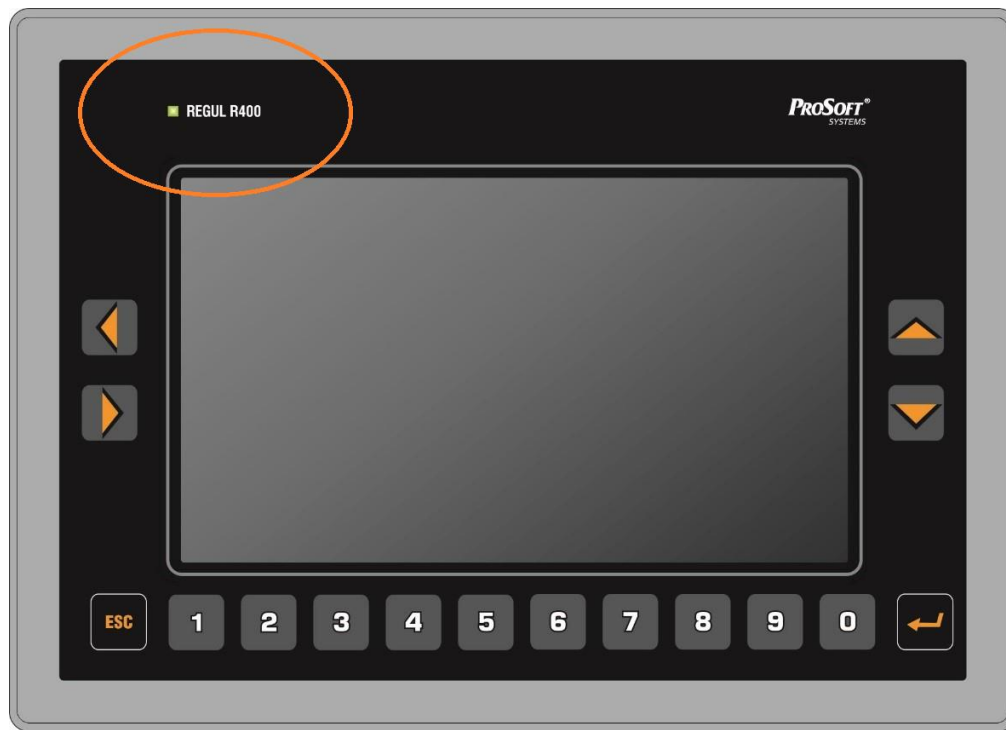
Рисунок 11 - Индикатор функционирования контроллера
